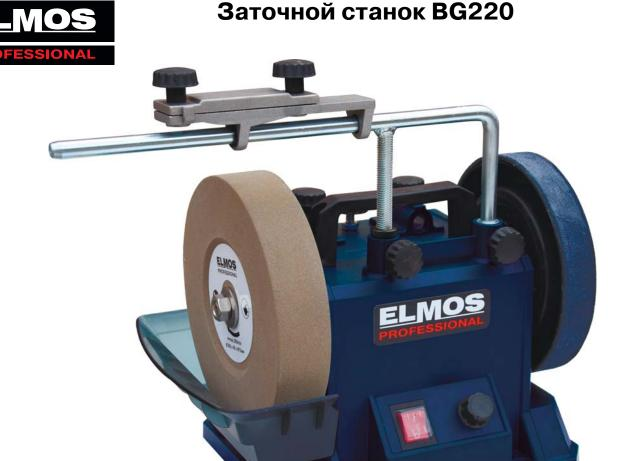
**BG220** применяются для заточки, доводки и шлифовки практически любого инструмента, обрабатывающего дерево и металл. Станок имеет мокрый заточный и полировальный круги. После шлифовки с водным охлаждением при низких оборотах работы станка, лезвие обрабатываемого инструмента приобретает абсолютно ровную поверхность, сталь остается твердой, а искрения не возникает. Мастер, работающий на станке, не подвергается опасности ожогов.
