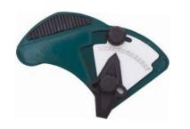
Измеритель угла заточки инструмента (калибр угловой)
