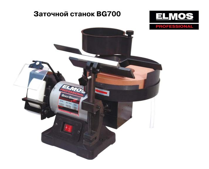
**BG-700** предназначен для правки любого режущего инструмента, например, ножей от рейсмусового станка или стамесок. Доводочный круг, характеризующийся очень малой зернистостью, вращается вокруг вертикальной, а не горизонтальной оси. Сверху над ним расположена ванна для охлаждающей жидкости, подающейся по каплям. Для соблюдения правильного угла заточки лезвий станок оборудован регулируемой по углу наклонным упором, снабжённым зажимным устройством.
