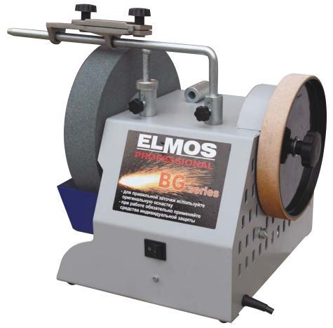
**BG200** применяется для заточки, доводки и шлифовки практически любого инструмента, обрабатывающего дерево и металл. Станок имеет мокрый заточный и полировальный круги. После шлифовки с водным охлаждением при низких оборотах работы станка, лезвие обрабатываемого инструмента приобретает абсолютно ровную поверхность, сталь остается твердой, а искрения не возникает. Мастер, работающий на станке, не подвергается опасности ожогов.
