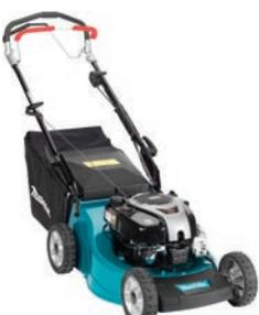
Механический привод на задние колеса для самоходного передвижения. Функция мульчирования. Алюминиевый корпус. Простая установка контейнера для травы. Надежные алюминиевые колеса на шарикоподшипниках. Мощный двигатель Briggs&Stratton 750 DOV EX с функцией ReadyStart.
