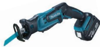
Высокая скорость реза с возможностью регулировки скорости. Быстрая замена ножовочного полотна при помощи шестигранного ключа. Регулировка упора без помощи дополнительного инструмента. DJR185 может использоваться как с пилами для сабельных пил, так и с пилами для лобзиков.
