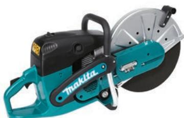
Увеличенный воздушный фильтр и новая система воздушной фильтрации эффективно защищает двигатель от проникновения пыли и грязи. Улучшенное охлаждение двигателя. Плавная регулировка направляющей с ручкой. Карбюратор с диафрагмой, электронное зажигание, механический стартер.
