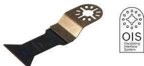
■ Насадка по металлу ВІМ М42 (за исключением закалённых саморезов и твердосплавных металлов); ширина 44 мм; глубина пропила 50 мм; толщина 0,8 мм; 18 TPI
